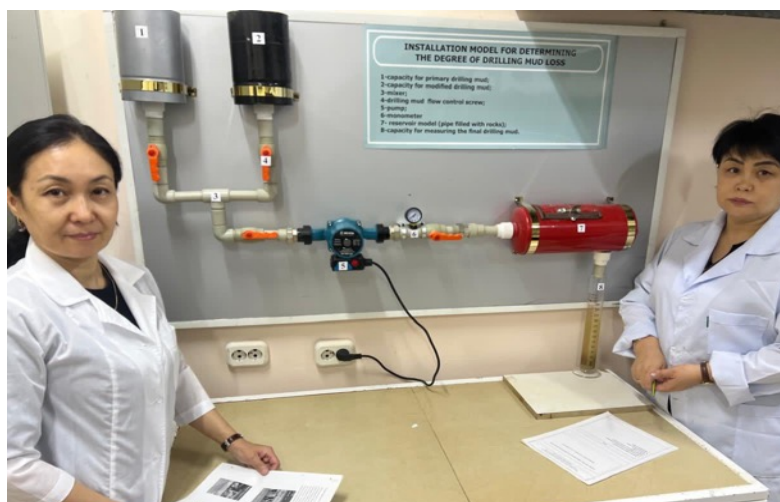
Сурет 1 – Бұрғылау ерітіндісінің сіңірілу дәрежесін анықтауға арналған қондырғының схемасы
