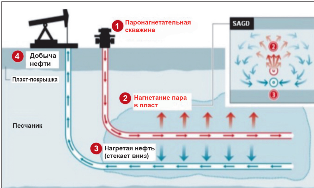
Рисунок 1 – Схема технологии добычи тяжелой нефти методом SAGD [1]
