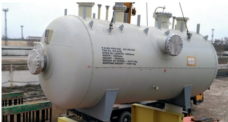
Рисунок 1 – Сосуд, работающий под давлением (факельный сепаратор) модель 391-D-02
