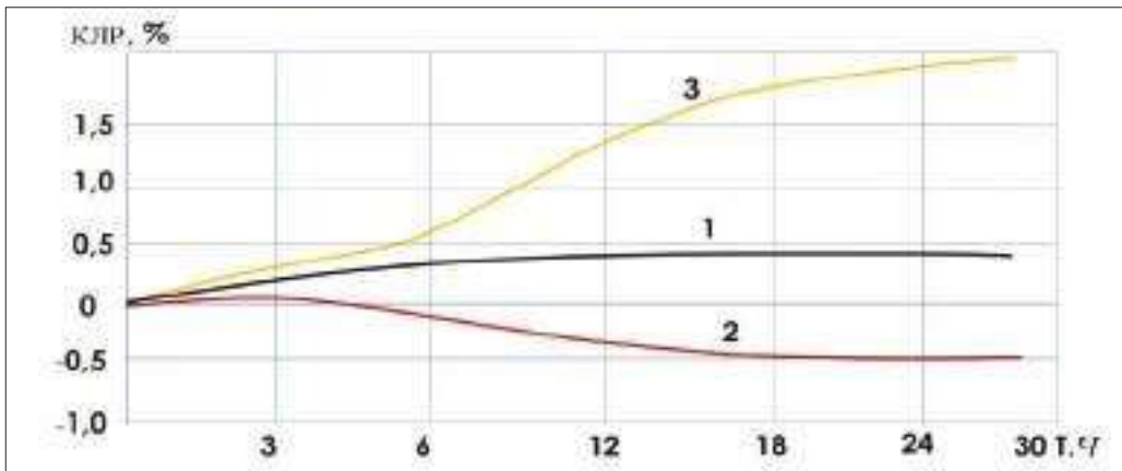
Рисунок 2 – Кинетика изменения объема цементного камня при твердении: 1 – в воде; 2 – на воздухе; 3 – в воде с расширяющей добавкой
