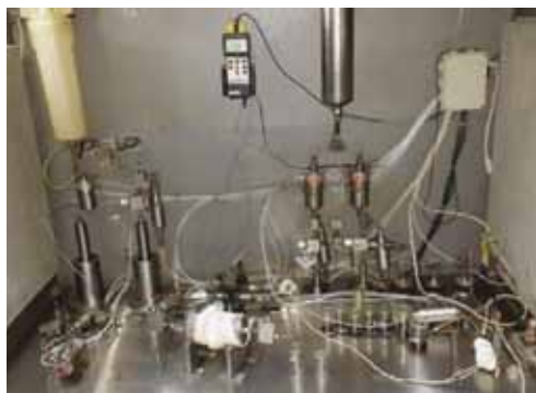
Рисунок 2 – Установка для исследования кернов УИК-С(2) (а) и физическая модель пласта (б)
