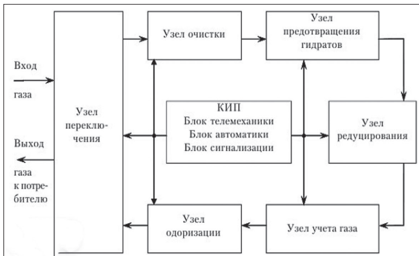
Рисунок 2 – Упрощенная схема АГРС
