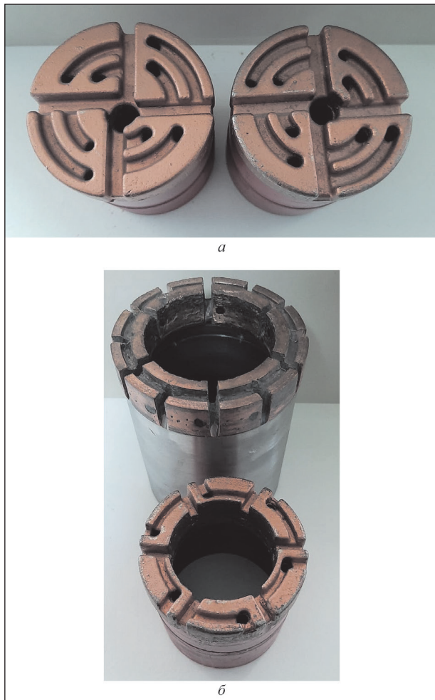
Рисунок 2 – Алмазные бурильные головки гидромеханического бурения скважин: а – со сплошным забоем; б – с отбором керна
