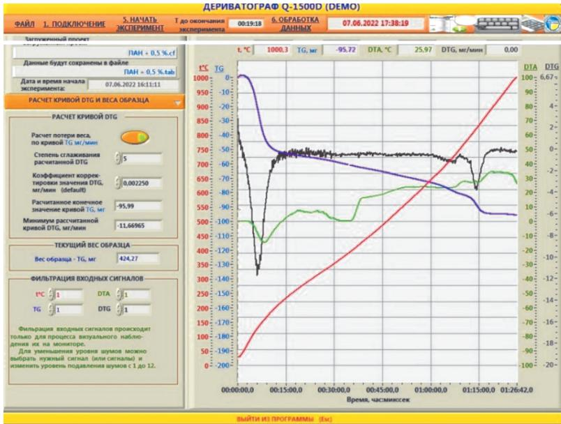
Рисунок 4 – ДТГ 15% водных дисперсий монтмориллонитовых глин месторождения Дарбаза в присутствии 0,5 % синтезированного сульфокислотного ВРП
