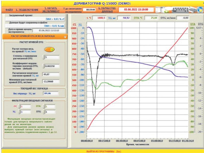
Рисунок 1 – ДТГ 15% водных дисперсий монтмориллонитовых глин месторождения Дарбаза в присутствии 0,01%-го синтезированного сульфокислотного ВРП
