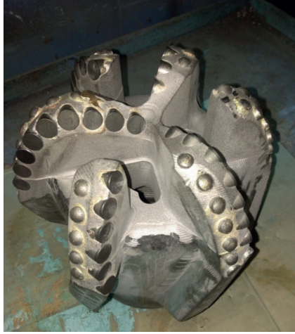
Рисунок 2 – Долото PDC с подрезными вставками в затылочной области лопастей
