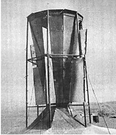
Рисунок 4 – Экспериментальная ветро-солнечная электростанция типа «Торнадо» мощностью до 5 кВт [150]
