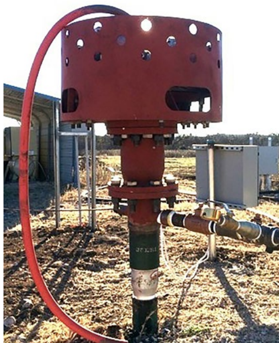
Рисунок 1 – Генератор SWEPT на скважине Вордлоу [54]
