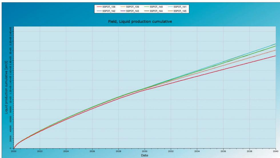
Рисунок 4 - Накопленные добычи жидкости с различными проницаемостями пропанта для моделирования ГРП с помощью заканчивания HydroFrac
