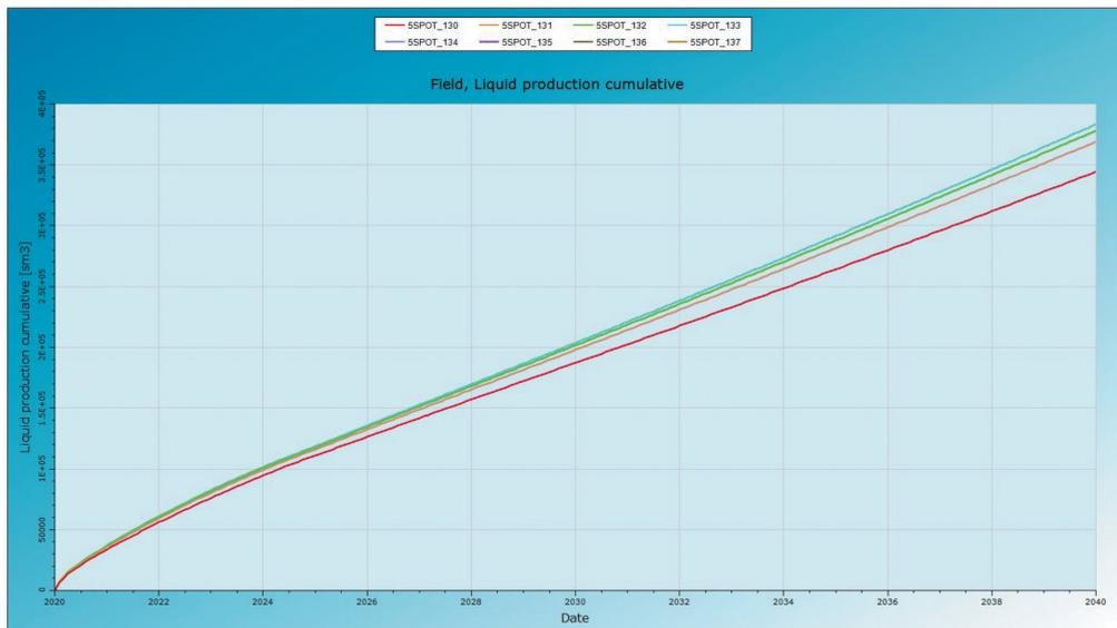
Рисунок 3 - Накопленные добычи жидкости с различными проницаемостями пропанта для моделирования ГРП с помощью плагина EasyFrac
