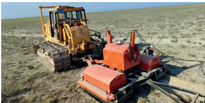
Рисунок 3 – Невзрывной импульсный электромагнитный источник возбуждения упругих волн
