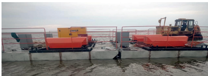
Рисунок 4 – Морской невзрывной импульсный электромагнитный источник возбуждения упругих волн
