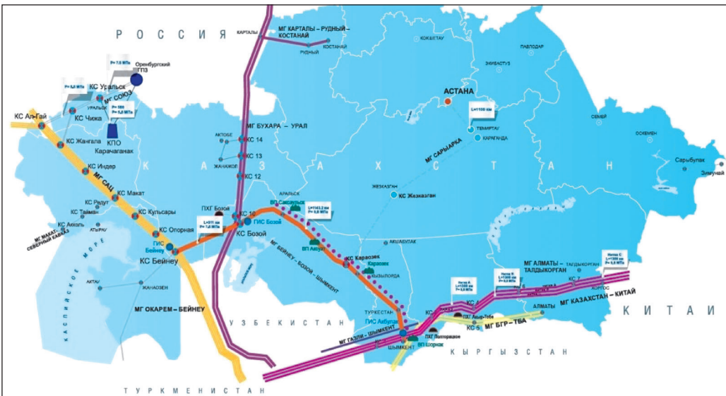
Рисунок 2 – Схема транзитных газопроводов, расположенных на территории Казахстана
