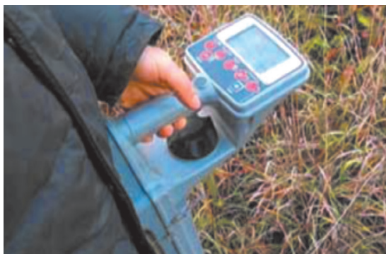
Сурет 5 - Radiodetection трасса детекторының көмегімен жер асты құбырының коррозиялық және механикалық зақымдану орнын анықтау
