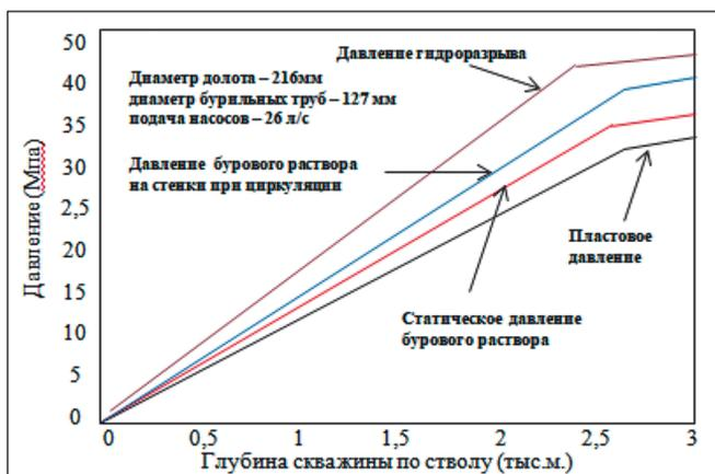
Рисунок 1 – Давление внутри скважины во время бурения
