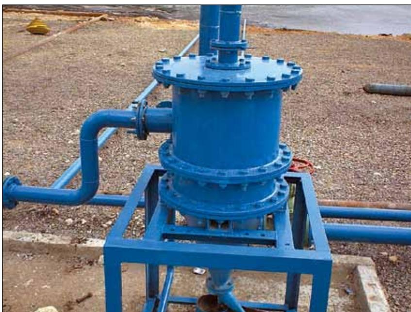
*Рисунок 5* — Наномолекулярный реактор гидроциклонный вертикальный с встроенными излучателями высокоинтенсивных ударных волн разрежения и электрического поля высокой напряженности
