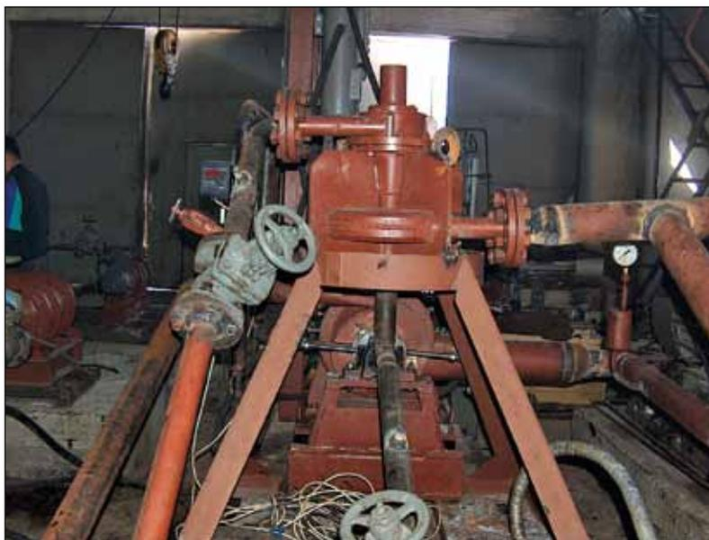
*Рисунок 6* — Наномолекулярный реактор гидроциклонный смешанный с встроенными излучателями ударных волн разрежения и электрического поля высокой напряженности
