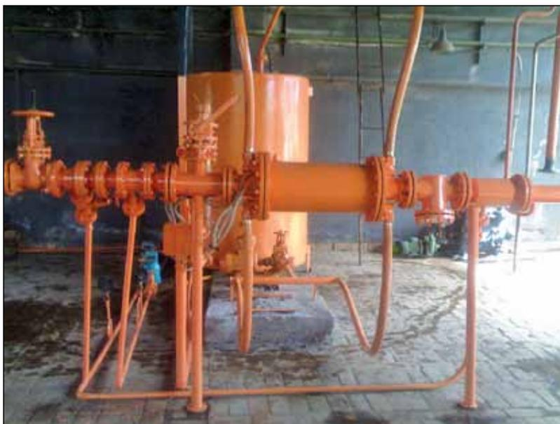
*Рисунок 7 — Наномолекулярный реактор обработки высокочастотным магнитным полем индуктивности одинарный*
