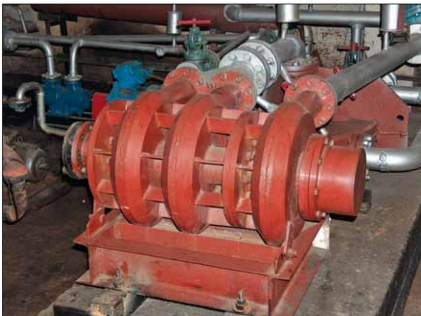
*Рисунок 4* — Наномолекулярный реактор гидроциклонный акустический горизонтальный с встроенными излучателями электрического поля высокой напряженности
