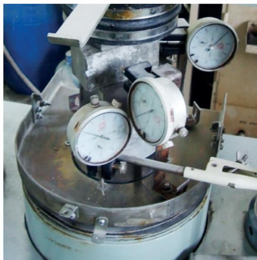
*Рисунок 3 – Индикаторы часового типа*
