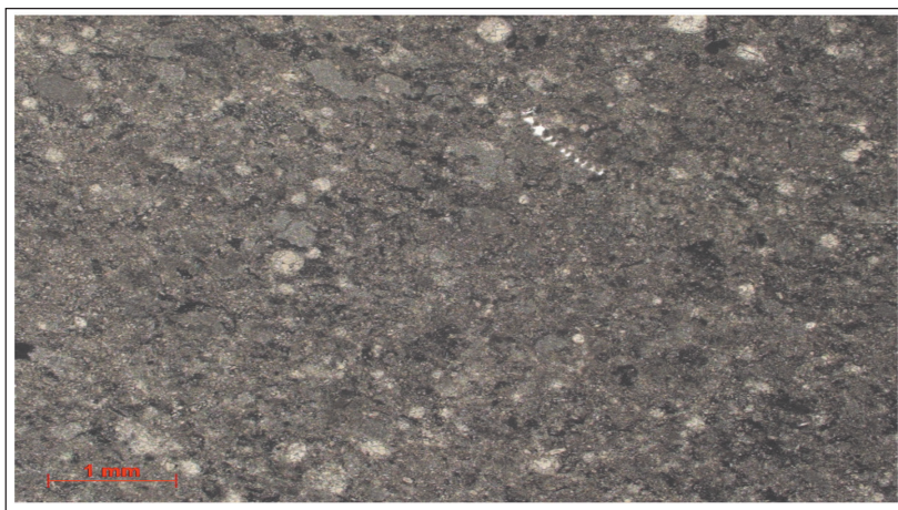
Рисунок 4 – Скважина Биюкжал СГ-2. Интервал глубин 5216,3-5221,3м. Без анализатора. Реликт обломка раковины пелециподы (?) и относительно равномерное распределение ОРО в известняке апорадиолариевом (вакстоуне)
