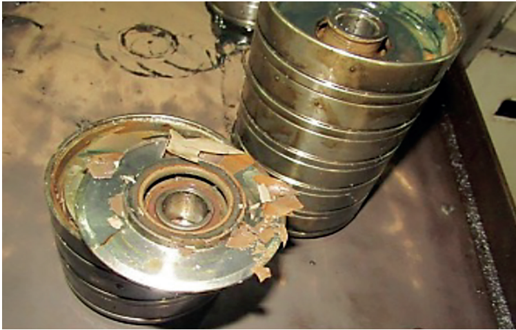
2-сурет – ЭОТС жұмыс органдарындағы тұз шөгінділері
