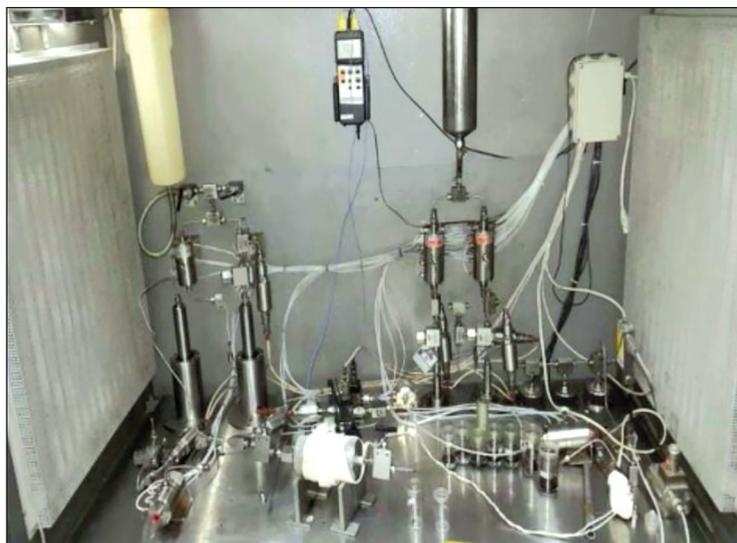
Рисунок 1 – Установка исследования кернов УИК-С(2)
