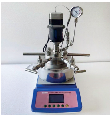
Рисунок 1 – Лабораторный реактор TGYF-C высокого давления для этерификации жирных кислот бутанолом
